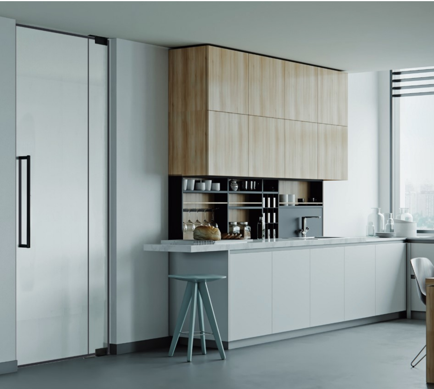
cusus 17 – BLACK|LINE, keramischer Digitaldruck | auf ExtraWeiß | Motiv matt schwarz | 1-flügelige Ganzglaspendeltür, geschosshoch | Hydraulik-Eckbeschlag – BLACK|LINE | Griffstange Uniquin – BLACK|LINE
